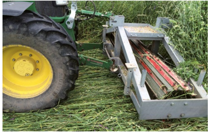
Messerwalze beim Walzen der Zwischenfrucht
