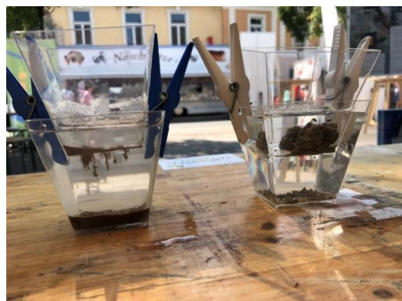
Abbildung 8: Prüfung der Aggregatstabilität – Slake Test (Fotos: Johannes Zauner, Verein Boden.Leben)
