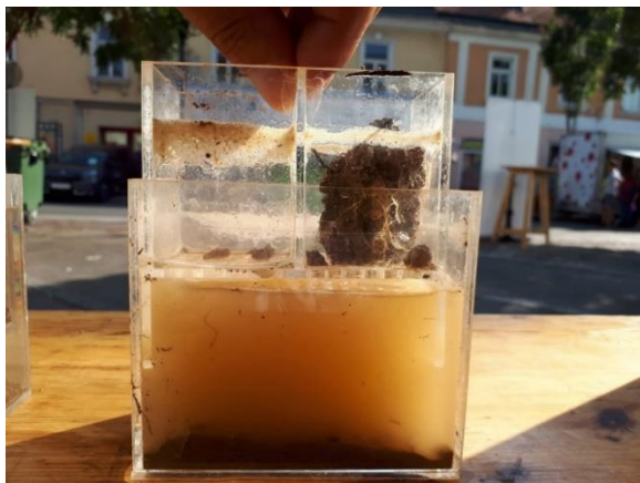
Abbildung 8: Prüfung der Aggregatstabilität – Slake Test (Fotos: Johannes Zauner, Verein Boden.Leben)
